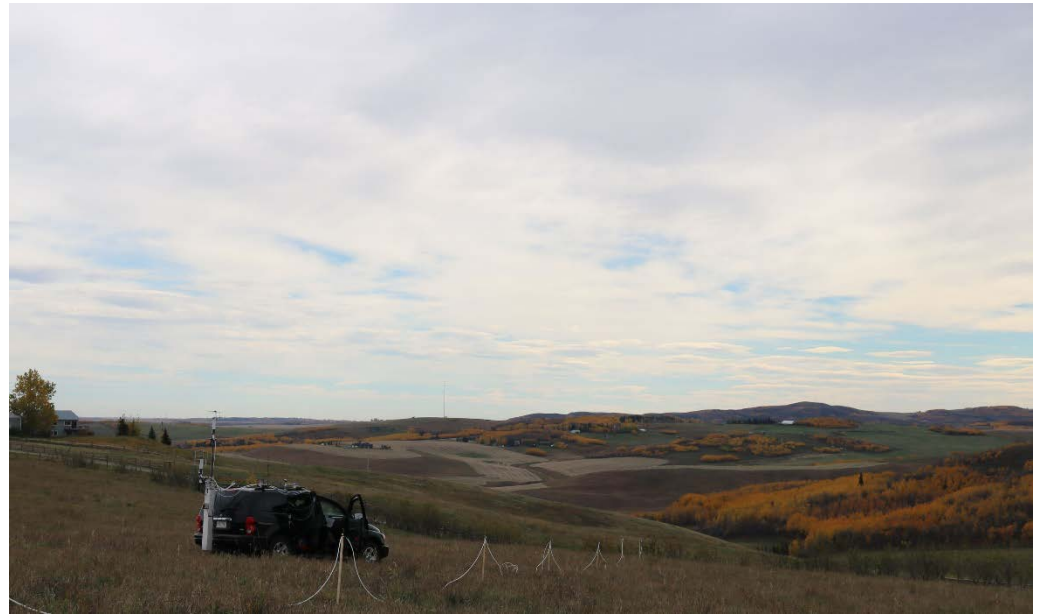
73米长线源, \text{CH}_4 释放速率0.00017 - 0.00057 kg/s
