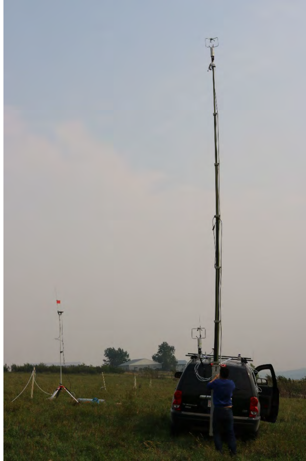
9米杆位于8个取样通道
