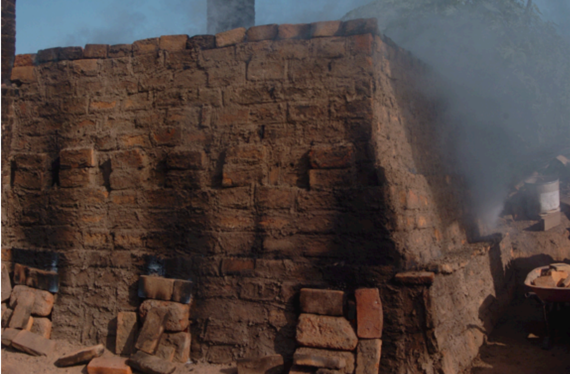
Horno típico de tipo campana, encontrado en Jalisco México. Característicamente ineficiente por su gran pérdida de calor y por su alta contaminación de carbono negro y otros gases tóxicos. Foto. JDTaillant
