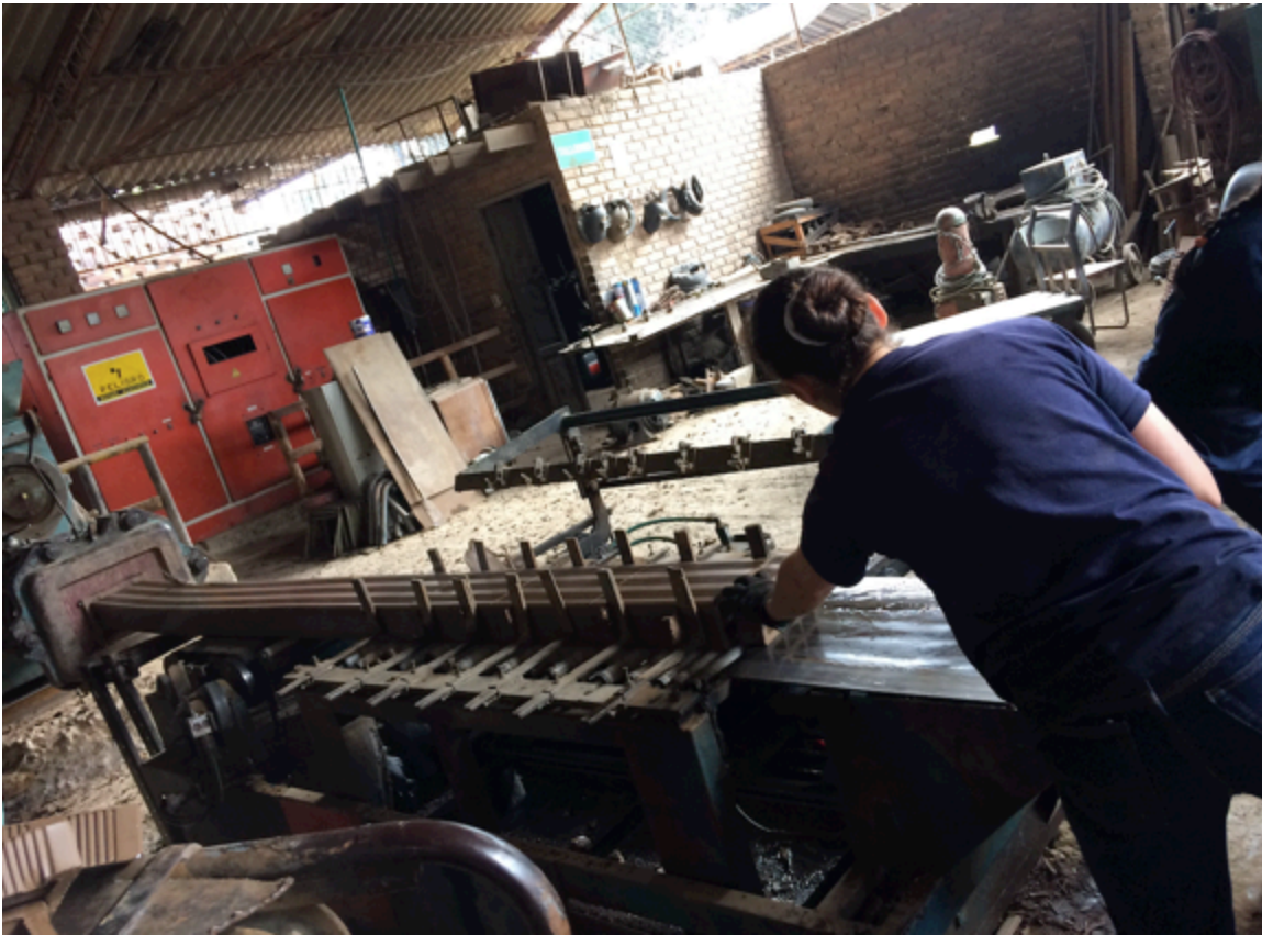
Se pueden introducir procesos mecanizados de corte de ladrillo. Aquí mujeres en Colombia realizan la tarea. Foto: JDTaillant
