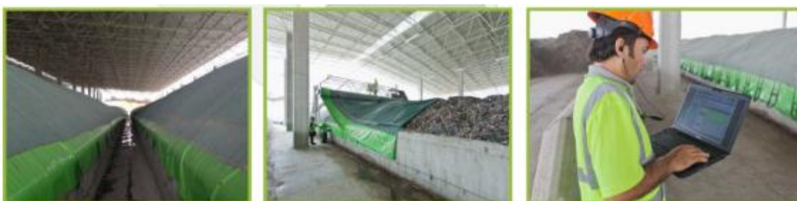
Figura 31. Vistas do sistema de membranas. Corredor entre trincheiras (esquerda), encapsulamento da leira (meio), controle online (direita).
