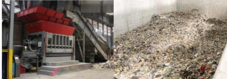
Figura 17. Triturador de CDR e vista geral de um CDR triturado.
